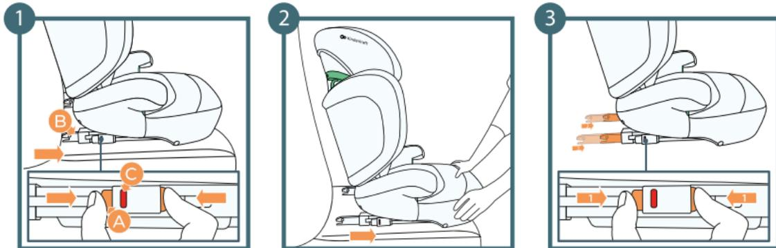
1. Pressiona simultaneamente os botões de desbloqueio ISOFIX em ambos os braços do sistema de fixação ISOFIX.
